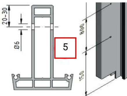
5. Statikkoppelungsprofil mit Ø6mm vorbohren, Bohrlochabstände lt. Verschraubungsschema (Abstand ca. 80 cm, von unten ca. 15 cm).
