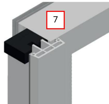
6. Statikkoppelungsprofil mit 4,8 x 45mm Selbstbohrschrauben auf das erste Elementschrauben.
