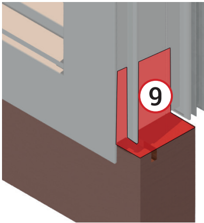
9. Auf Kontaktfläche großzügig Dichtkleber auftragen
