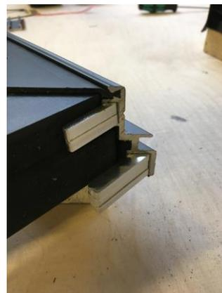
3. Die Elemente mit den vormontierten Robalonteilen zusammenstecken und mit 3,5x20mm Schrauben (aus dem Beipack), oben und unten verschrauben. Darauf achten das die Rahmenteile bündig sind, gegebenenfalls ausrichten.
