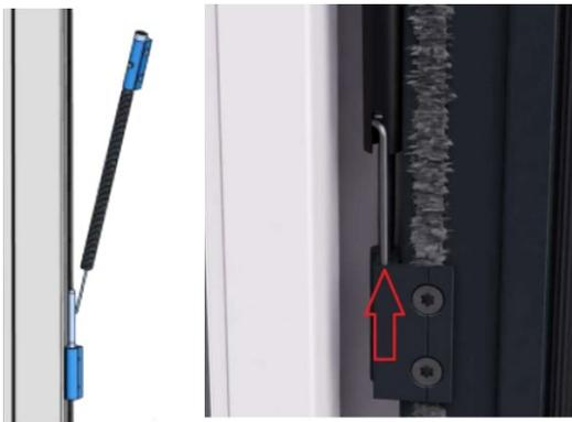
8. Scharnieroberteil am Montagerahmen ausrichten und befestigen. Anschließend Türflügel wieder schließen.
