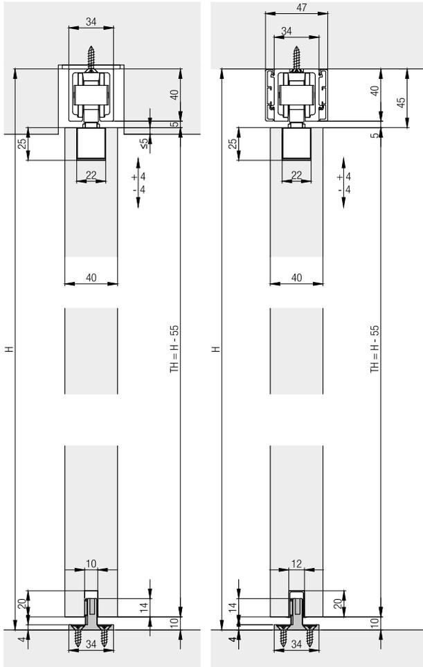
Weitere Einbaubeispiele mit Distanzschiene
