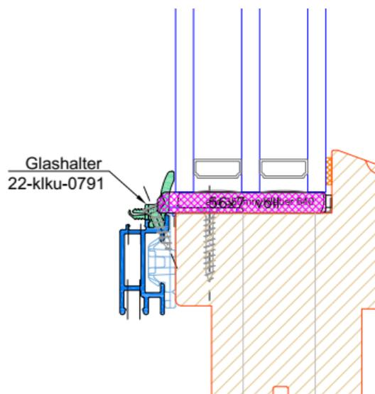
4. Glashalterahmen einklipsen (Abb.3). Dabei darauf achten, dass die Dichtung am Stock seitlich und oben eingezogen ist. Unten ist keine Dichtung vorgesehen, um eine optimale Entwässerung und Belüftung zu erzielen.
