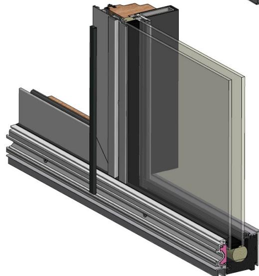
2. Anschließend das Klemmprofil unten aufschrauben, noch nicht fest anziehen. Innendichtung wie bereits beschrieben eindrücken. Im Anschluss das Klemmprofil unten festschrauben. Füllprofil über die ganze Länge eindrücken. Anschließend das Grundprofil aufsetzen und mittels Rundkopfschrauben verschrauben. Anschließend die Abdeckung aufklipsen oder Dichtung einziehen. Zum Schluss das Grundprofil beidseitig senkrecht versiegeln.
