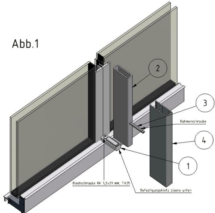
2. Anschließend das Klemmprofil unten aufschrauben, noch nicht fest anziehen. Innendichtung wie bereits beschrieben eindrücken. Im Anschluss das Klemmprofil unten festschrauben. Rundprofil über die ganze Länge eindrücken. Anschließend das Grundprofil aufsetzen und mittels Rundkopfschrauben verschrauben. Im Anschluss die Dichtung einziehen oder die Abdeckung aufklipsen. Zum Schluss das Grundprofil beidseitig senkrecht versiegeln.
