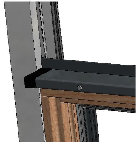
3. Die Länge des Überschubprofiles kontrollieren und gegebenenfalls noch kürzen. Danach auf der oberen/unteren Seite (je nachdem ob Ober- oder Unterlichte) des Überschubprofiles an der/n Seite/n, an der/n sich der Robalonklotz befindet, ein Loch bohren und ansenken. Das Lisenen Überschubprofil auf die Stahlversteifung aufstecken und in das vorgebohrte Loch mit einem Senkkopfschrauben (2) verbinden.
