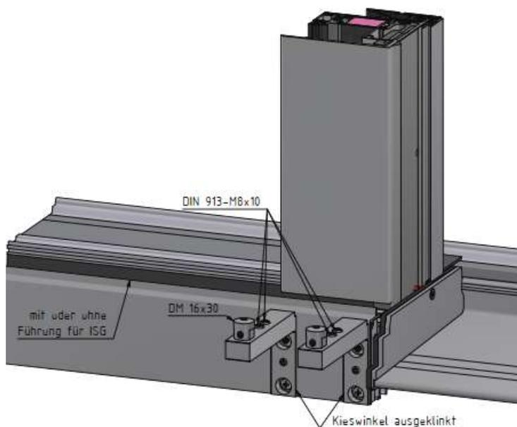
2. Seilhalter auf Klemmprofil aufsetzen, positionieren und mittels Wurmschraube fixieren. Im Anschluss mit Rundkopfschraube (Spannschraube) festschrauben. Zusätzlich kann der Seilhalter mit einer Linsenkopfschraube gesichert werden. (Dient zur Winkelgerechten Ausrichtung) Anschließend Spannseilhalter eindrehen.
