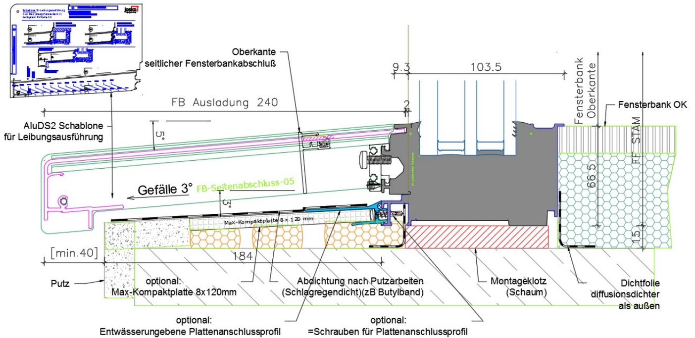
Montageset: **720107255 - MS0119** FF-EBT-Entwässerungsebene - Plattenanschluss
