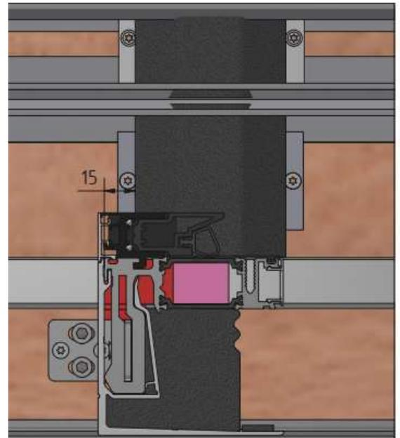
Bei einer Stufenglas Ausführung muss der Abdeckwinkel des Dichtstehers vor der Montage der Glasscheibe befestigt werden.
