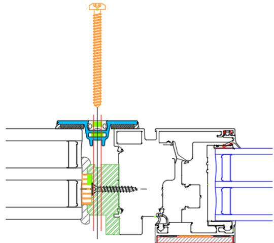
3. Die Klebebänder je nach Glasstärke auf das innere Alu aufbringen und positionieren. Dann kann die Lisenen mit den zuvor eingesteckten Schrauben befestigt werden. Danach mit der Montage der Statiklisenen vorgehen.
