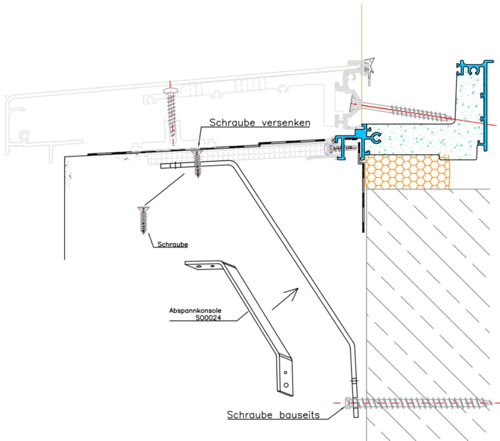
2. Anschließend die Aufnahme Spannschraube aus **Montageset 720105832 - MS0113** mit Hilfe des Seilhalters positionieren und auf der Max-Kompaktplatte verschrauben.
