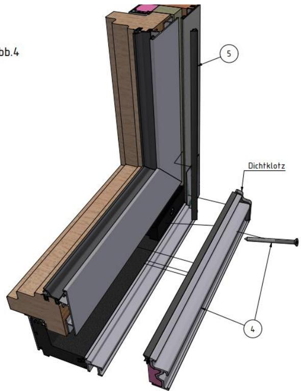
5. Im Bereich wo Elemente oben oder seitlich an den Systemrahmen anschließen Dichtung (ACHTUNG: ist bei den Nurgläsern die schmale TPE Innendichtung) eindrücken. Unter dem Element zwischen Fenster und LPU das Rundprofil einbringen.
