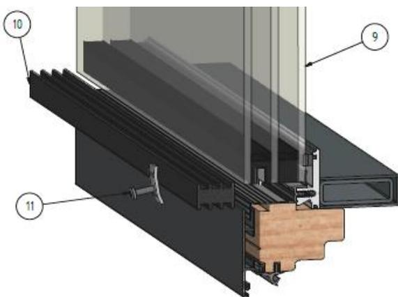
3. Glasscheibe einfädeln und auf die Glasauflagen absenken. Den Inlethalter mit einer Vorstechahle incl. der Schraube einheben und mit der Hand festschrauben (empfohlen: 20 Nm). Dabei auf Flächenbündigkeit und Fugenspaltmaß achten und schließlich kann das Füllprofil über die ganze Länge der Glasscheibe mit einer stumpfen Montagehilfe eingedrückt werden.
