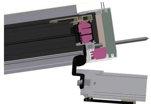
3. Danach kann das zuvor entfernte Drehband wieder mit den 2 Schrauben befestigt werden und der Flügel kann eingehängt werden.
