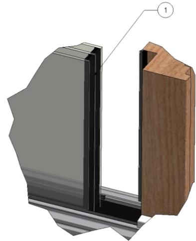
2. Rundprofile (Rundschnüre 20 mm) mit einer stumpfen Montagehilfe eindrücken und ausrichten. Diese Rundschnüre müssen über die gesamte Länge der Isolierglasscheibe gehen. Scheiben ausrichten, auf Flächenbündigkeit und auf ein exaktes Fugenspaltmaß achten. Anschließend den Dichtstoff Ramsauer Fassade 350 gleichmäßig und blasenfrei in die Fuge einbringen und innerhalb von 10 min abziehen.
