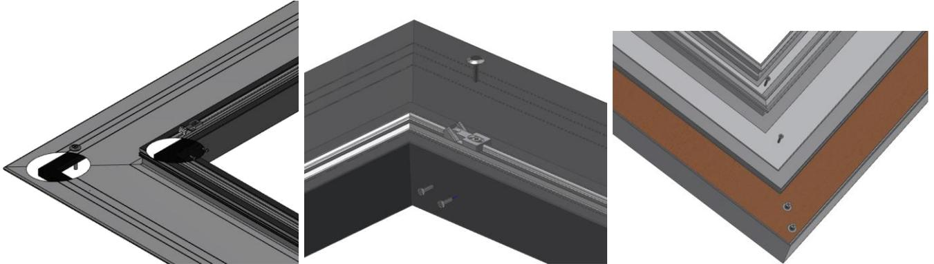
2. Beim Einrichten der Bodenschwelle ist darauf zu achten das die Bodenschwelle sowohl innen als auch außenseitig über die ganze Länge in der Waage ist und an keiner Stelle durchgebogen ist. Das ist wichtig da sonst der Abstand der Flügel zueinander im Eck nicht fluchten.
