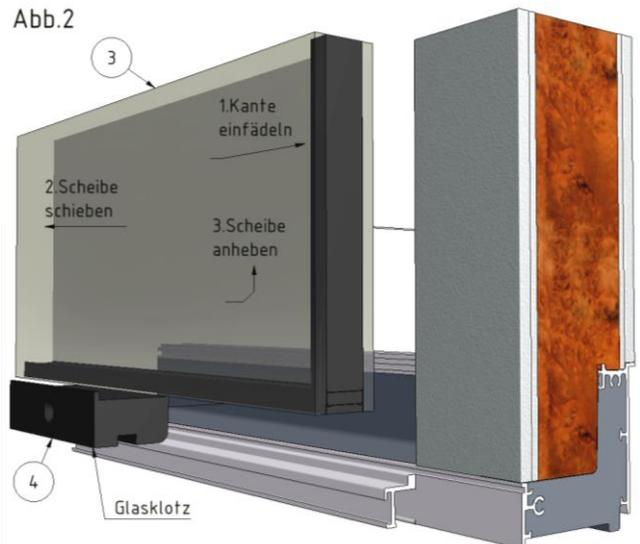
4. Bei Monoscheiben werden aufgrund des geringeren Glaseinstands die grünen Unterlagsklötze unterhalb der Glasklötze eingebaut
