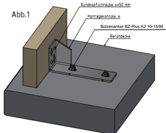
**ACHTUNG:** Beträgt der Abstand zwischen Betonvorderkante und Elementvorderkante (Abstand X lt. Seite 29) mehr als 140 mm ist bei Hebeschiebetüren und Schiebetüren im Bereich der Laufschiene der Abstand zwischen den Montaeconsolen auf 300 mm zu reduzieren.
