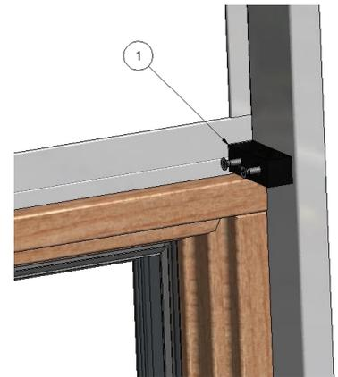
3. Im Anschluss die waagrechte Stahlversteifung mit dem Adapterprofil verschrauben
