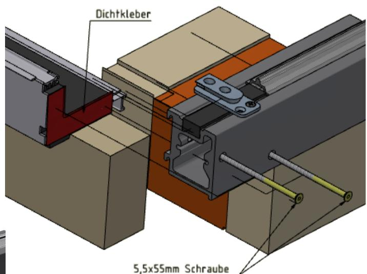
Ein Kompriband auf die Aluoberkante des LPU Profilers vom GFK Profil bis zur Vorderkante des Thermoprofils kleben um das Kompriband und um den Anschluss zum GFK Profil großzügig mit Ramsauer 640 verfüllen. Klemmprofil einfädeln und mit 4x30mm Schrauben befestigen.
