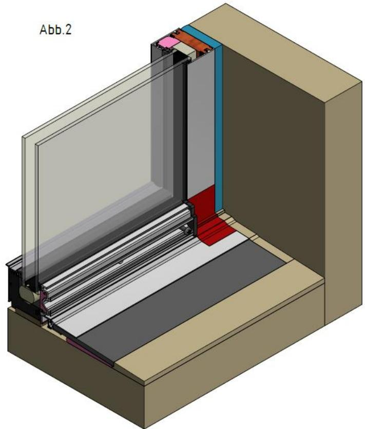
4. Hannoband 10x10 auf Abb. 4 sichtbar am Fensterbankanschluss aufkleben Mauerseitigen Fensterbankabschluss einhängen nach unten drücken und mittels Sicherungsschraube festschrauben.
