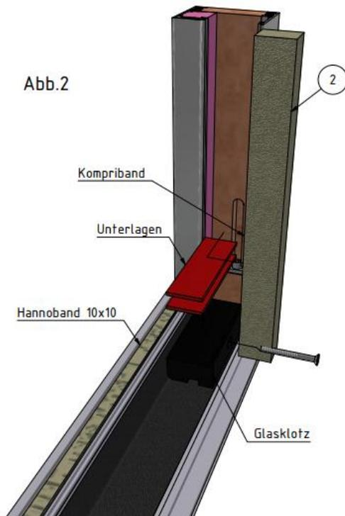
2. Vor dem Einsetzen der Verglasung in den Systemrahmen seitlich und oben Kompriband 8x40 mm am inneren Schaum anliegend über die ganze Länge einkleben. Weiters ist am unteren Systemrahmen über die ganz Länge des Elementes ein Kompriband 10 mm zu kleben.
