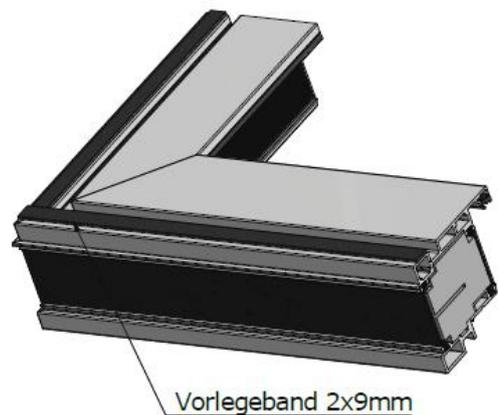
2. Vor dem Einsetzen der Verglasung in den Systemrahmen seitlich und oben Komtriband 30 mm am inneren Schaum anliegend über die ganze Länge einkleben.
