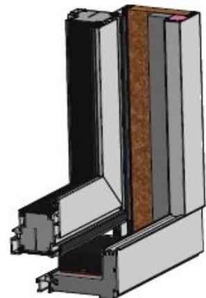
4. Dichtklotz mauerseitig auf das Klemmprofil aufkleben. Klemmprofil aufsetzen und festschrauben.
