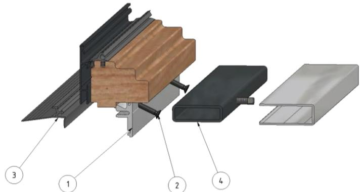
2. Auf das Adapterprofil, die für die Glasstärke nötigen Vorlegebänder kleben. Glasscheibe einfädeln und fixieren.
