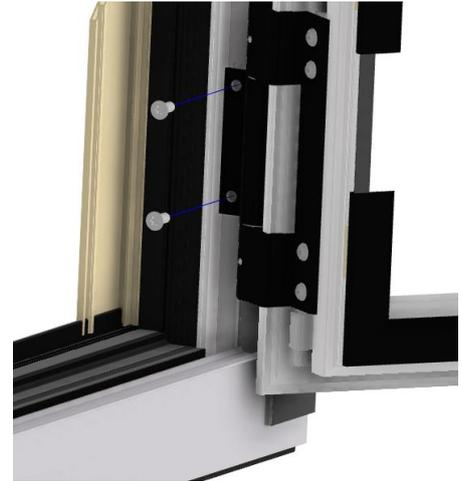
2. Bei jedem Band mittig zwischen den beiden Löchern der Bandbefestigung mit einem 8er Bohrer durch den Stock und Systemrahmen Fixfram durchbohren. Mit einem in der Länge passenden AMO-Schraube danach befestigen. Schraubenkopf mit dem Alu bündig einschrauben.
