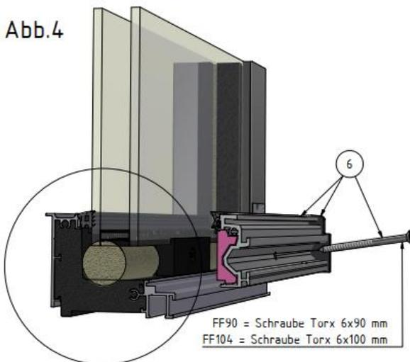
7. Vor dem Anbringen des Klemmprofils Schraube bei Glasklotz lockern. Dichtklotz mauerseitig auf das Klemmprofil kleben. Klemmprofil incl. eingezogener Dichtung aufsetzen und nur leicht mit den Schrauben sichern. Scheibe darf nicht angedrückt werden! Das Klemmprofil darf nicht an den Glasklotz angeschraubt werden.
