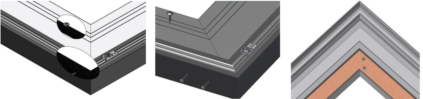
2. Beim Einrichten der Bodenschwelle ist darauf zu achten das die Bodenschwelle sowohl innen als auch außenseitig über die ganze Länge in der Waage ist und an keiner Stelle durchgebogen ist. Das ist wichtig da sonst der Abstand der Flügel zueinander im Eck nicht fluchten.
