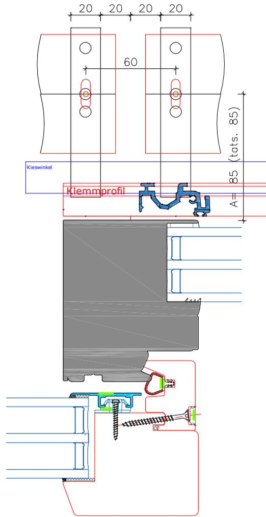
**Abb. 17 Montage Seilabspannung einfach
