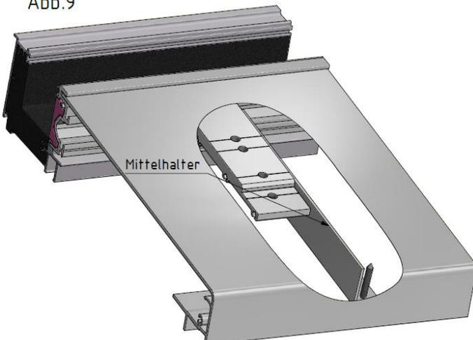
4. Montage der mechanischen Verriegelung bei durchgehenden Längen über 4 m. Mittelhalter seitlich am Seilhalter mittels 4,2x19mm Senkkopfschrauben befestigen.. Fensterbank einhängen, Verriegelung und Fensterbank miteinander an der Unterseite verschrauben.
