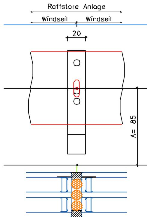
**Abb. 18 Montage Seilabspannung doppelt
