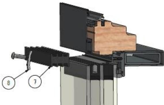
3. Den Inlethalter mit einer Vorstechahle incl. der Schraube einheben und mit der Hand festschrauben (empfohlen: 20Nm). Dabei auf Flächenbündigkeit und Fugenspaltmaß achten und schließlich kann das Füllprofil über die ganze Länge der Glasscheibe mit einer stumpfen Montagehilfe eindrückt werden.
