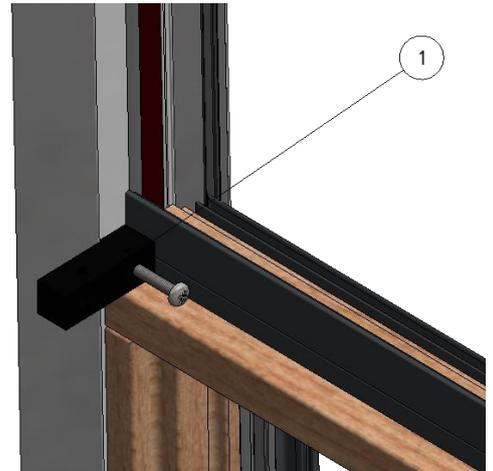
2. Im Anschluss die waagrechte Stahlversteifung mit dem Adapterprofil verschrauben
