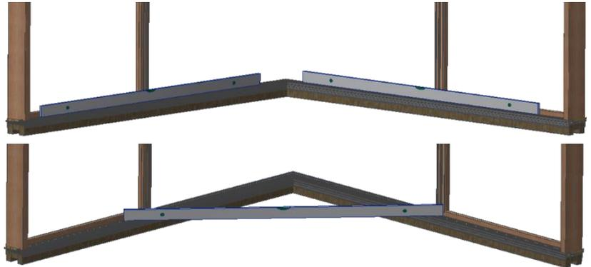
3. Das Brüstungsalu für den Durchgang muss noch an der Gehrung mit einem Butylband abgedichtet werden.
