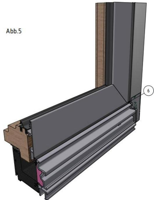
6. Die unteren Dichtungsecken mit Dichtstoff verschließen.
