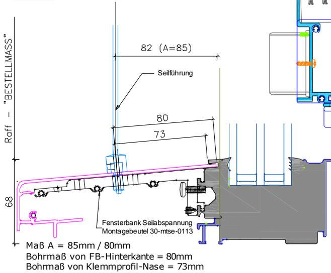
**Abb. 16 Montage Seilabspannung doppelt Variante Hebeschiebetür**
