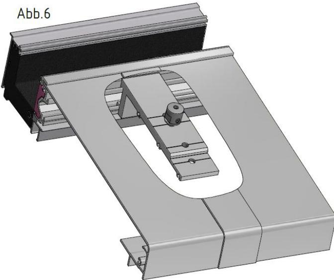
2. Montage des Halters wie unter Abb. 4. Variante Längsstoß der Designfensterbank. Abdeckung aufsetzen, Loch in die Abdeckung bohren und Spannseilhalter incl. Unterlegscheibe Kunststoff eindrehen.
