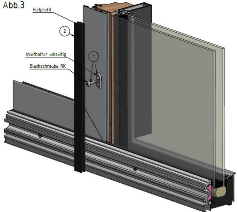
3. Nach dem Positionieren des Füllprofils kann die Fuge mit Dichtstoff 350 vollflächig gefüllt und bündig abgezogen werden.
