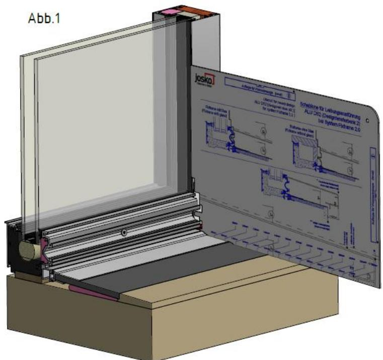
3. Die Mauer muss wie angegeben bis zum Aluprofil abgedichtet werden.
