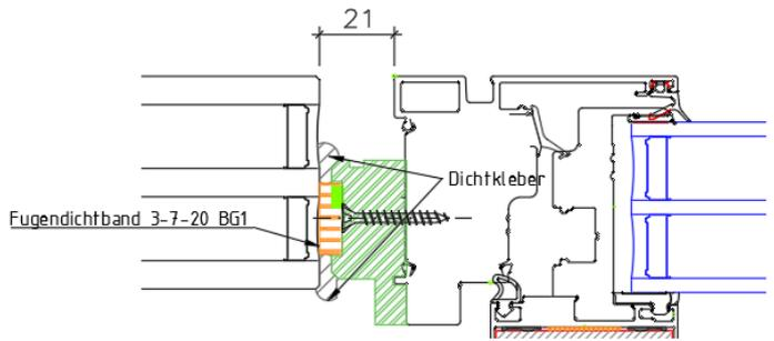
2. Das Lisenenprofil außen anhalten und positionieren. Durch die vorgegebenen Löcher der Lisenen mit einem 5mm Bohrer durch die Leiste bohren. Danach die Schrauben, die sich im Montagebeutel befinden durch die vorgebohrten Löcher stecken.
