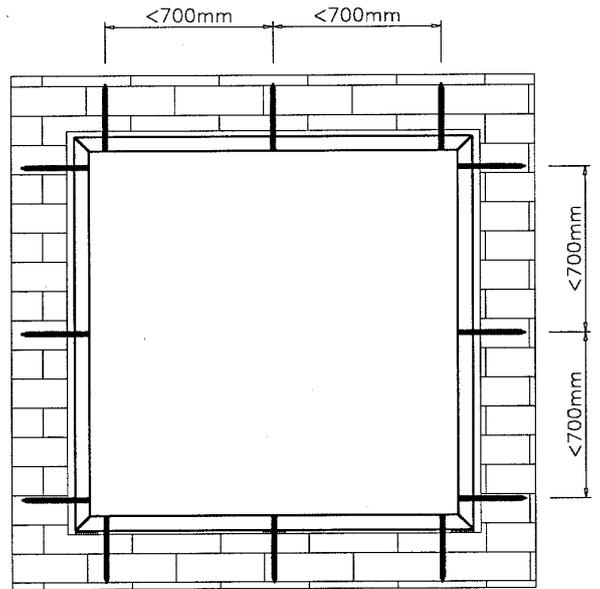
Bei der Montage vor dem Mauerwerk sind die gleichen Richtlinien bei der Befestigung anzuwenden. Die dafür notwendigen Montagmaterialien sind schon bei Naturmaßnahme zu planen und zu bestellen.
