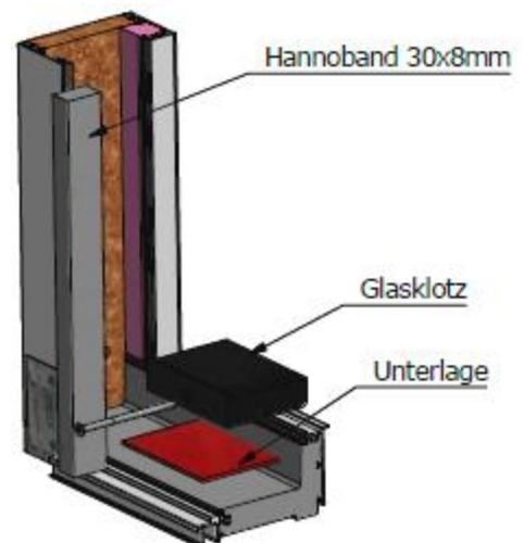
3. Element oben einfädeln, eindrehen und in den seitlichen Systemrahmen einschieben.
