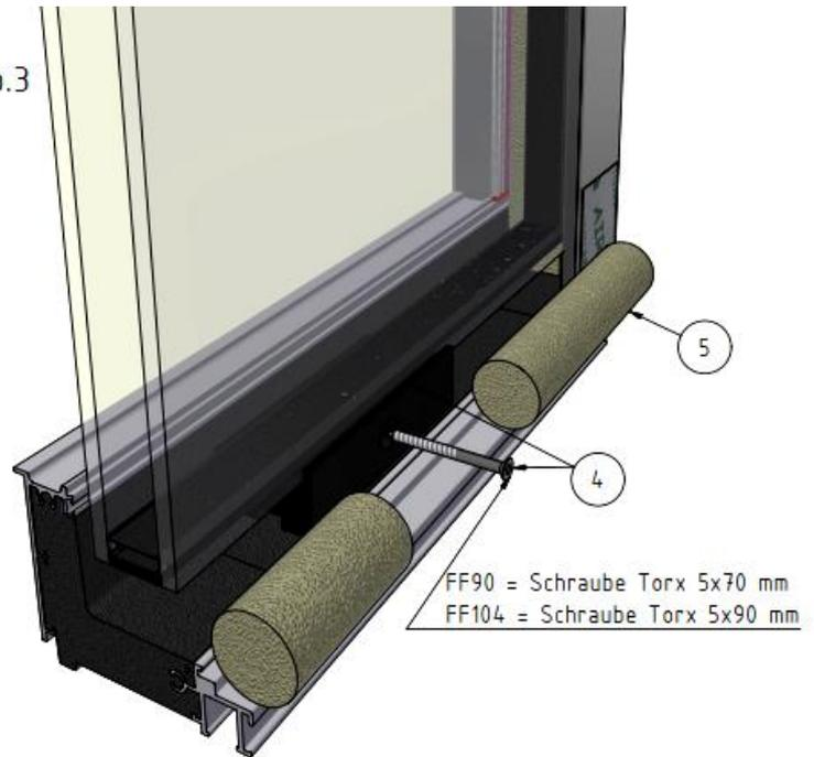
6. PE-Rundprofil 30 mm in den Glasfalz unter der Glasscheibe eindrücken.
