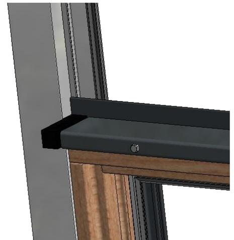
3. Die Länge des Überschubprofils kontrollieren und gegebenenfalls noch kürzen. Danach auf der oberen/unteren Seite (je nachdem ob Ober- oder Unterlichte) des Überschubprofils an der/n Seite/n, an der/n sich der Robalonklotz befindet, ein Loch bohren und ansenken. Das Lisenen Überschubprofil auf die Stahlversteifung aufstecken und in das vorgebohrte Loch mit einem Senkkopfschrauben (2) verbinden.
