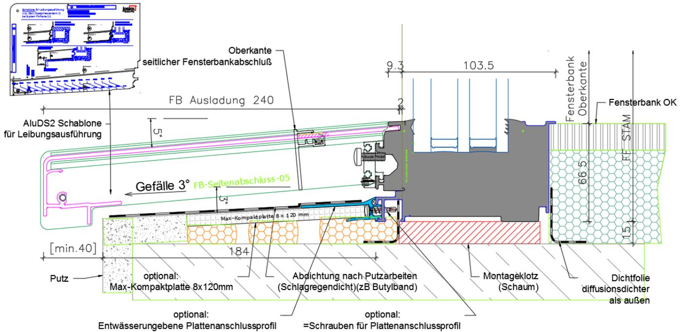
Montageset: **720107255 - MS0119** FF-EBT-Entwässerungsebene - Plattenanschluss
