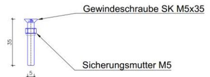
3. Auflaufklotz am Entwässerungsschachtgitter montieren.
