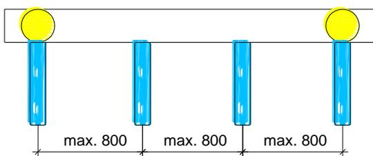
Bevor die Konsolen mit dem Boden verdübelt werden, ist vorerst der untere Systemrahmen in der Maueröffnung in die richtige Position zu bringen. Anschließend ist an den äußeren Lastabtragungspunkten bzw. an den Lastabtragungspunkten an den Ecken jeweils eine Konsole zu setzen und der Systemrahmen an den Konsolen gerade auszurichten. Danach sind an den restlichen Lastabtragungspunkten und dazwischen (max. 800 mm Abstand) die jeweiligen Konsolen zu montieren.
