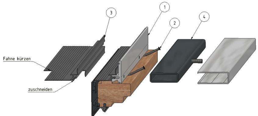
Die Stahlversteifung mit einem 2,5 mm Abstand zum Fensterelement positionieren und die Position der Bohrlöcher in der Stahlversteifung an dem Adapterprofil markieren. Anschließend mit einem 6 mm Bohrer vorbohren und die Stahlversteifung mit den Rahmenschrauben befestigen. Lisenen Überschubprofil mit der Nase nach oben auf die Stahlversteifung aufstecken.
