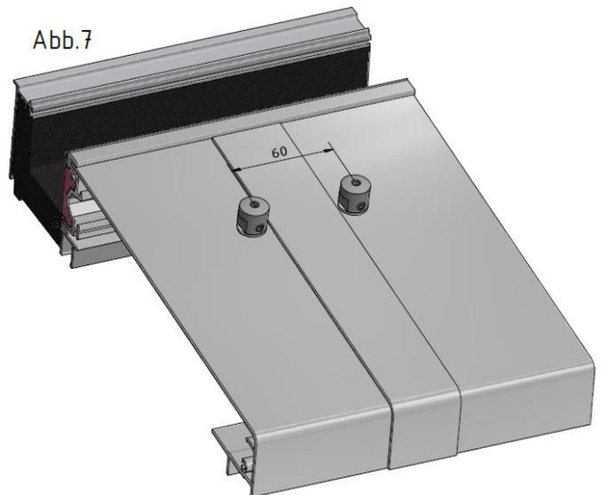
3. Montage der Halter wie unter Abb. 4 Variante Längsstoß der Designfensterbank. Abdeckung aufsetzen, Löcher im Abstand von 60 mm in die Fensterbank bohren und Spannseilhalter incl. Unterlegscheibe Kunststoff eindrehen.
