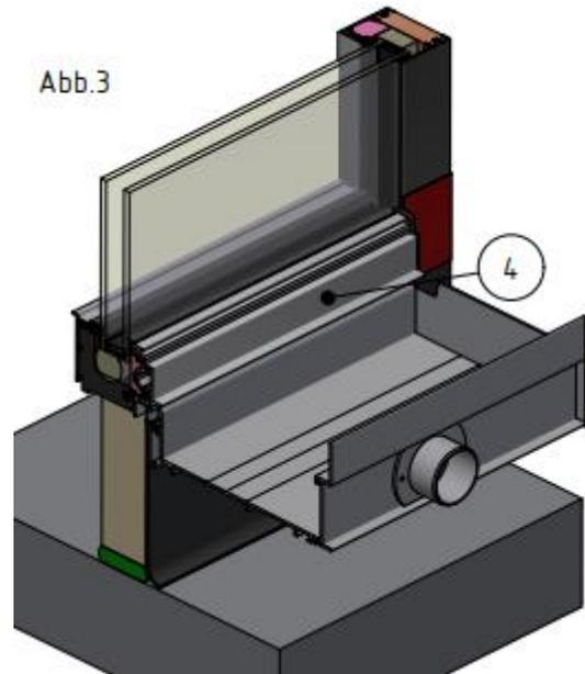
4. Bei Entwässerungsschächten über Eck und bei Längsstößen, wird der mitgelieferte Verbindungswinkel mittels Dichtkleber und Nieten befestigt.
