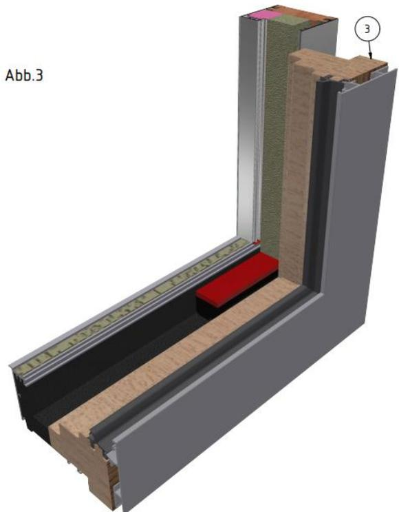
4. Dichtklotz mauerseitig auf das Klemmprofil aufkleben. Klemmprofil aufsetzen und festschrauben.
