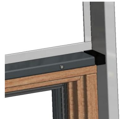
4. Die Länge des Überschubprofils kontrollieren und gegebenenfalls noch kürzen. Danach auf der oberen/unteren Seite (je nachdem ob Ober- oder Unterlichte) des Überschubprofils an der/n Seite/n, an der/n sich der Robalonklotz befindet, ein Loch bohren und ansenken. Das Lisenen Überschubprofil auf die Stahlversteifung aufstecken und in das vorgebohrte Loch mit einem Senkkopfschrauben (2) verbinden.
