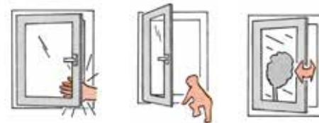
Vermeiden Sie, dass Fenster- und Türflügel unkontrolliert (z.B. durch Wind) so gegen den Baukörper oder den Endanschlag geworfen werden, dass die Beschläge, Rahmenmaterialien oder sonstige Teile beschädigt oder zerstört werden bzw. Folgeschäden entstehen können.
