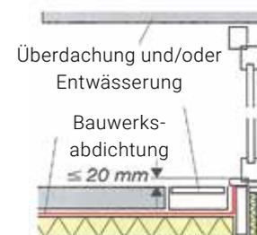
Nach ÖNORM B 3691 können Türanschlüsse bei ungeschützter und teilgeschützter Einbaulage bei Einhaltung von Mindestbreiten und Höhen eines Entwässerungsschachtes barrierefrei ausgeführt werden (Abb.) Folgende Anforderungen müssen eingehalten werden:
