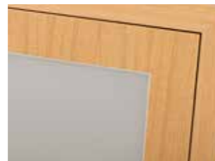
Glasleiste Alu 0920 Das Glas ist bündig zum Türblatt. Erhältlich in Alu natur, weiß oder schwarz matt
