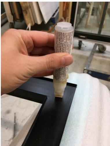
4. Das mitgelieferte Klebeband 1x20mm mittig auf das Aluprofil aufkleben. Die senkrechten Klebebänder werden durchgeklebt.
