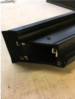
2. Bei der gegenüberliegenden Ecke wurden die Robalonwinkel oben und unten bzw. auch ein Teil der Alu-Eckwinkel bereits werkseitig vormontiert. Die restlichen Alu-Eckwinkel aus dem Montagebeutel lt. Grafik (1. Seite) zusammenstecken.
