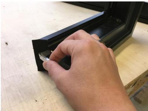
3. Die Elemente mit den vormontierten Robalonteilen zusammenstecken und mit 3,5x20mm Schrauben, oben und unten verschrauben. Darauf achten das die Rahmenteile bündig sind, gegebenenfalls ausrichten.
