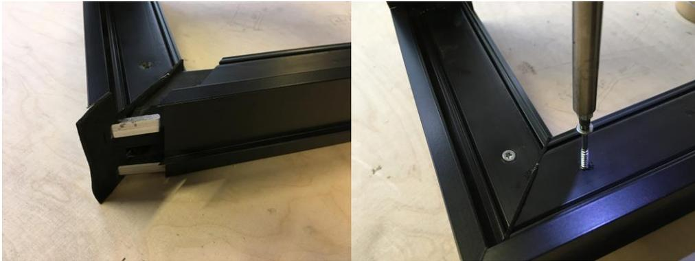
4. Über die Gehrung wird mit dem mitgelieferten Airstopband aus dem Montagebeutel zusätzlich abgedichtet.
