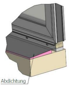
5. Der seitliche Hochzug ist ebenfalls mittels Foliendichtbänder herzustellen. Die offenen Fugen sind mittels Dichtkleber zu verschließen.
