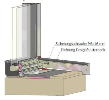
4. Am Klemmprofil Silikon aufbringen um ein späteres dröhnen der Fensterbank zu verhindern. Dichtungen der Fensterbankanschlüsse mit Gleitspray (Silikon) behandeln, gleich im Anschluss die Fensterbank aufschieben und mit Sicherungsschrauben anheben, oben am Klemmprofil ansetzen und eindrehen. Anschließend mit Schraube 4,2x25mm sichern.
