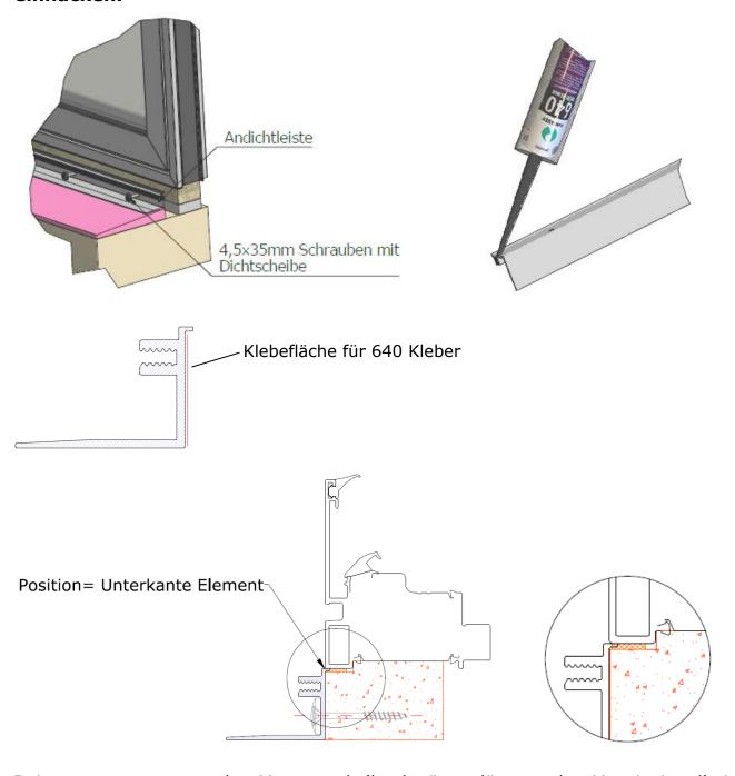
2. Bei monotonem tragenden Mauerwerk (hochwärmedämmenden Massivziegel), ist das untere Thermoprofil mit einer Höhe von min. 50mm zu bestellen. Mit der mitgelieferten Schablone bzw. mit diversen Gradmessgeräten wird die Laibungsausführung der Mauer festgelegt. Die Schablone wird lt. Aufdruck verwendet.
