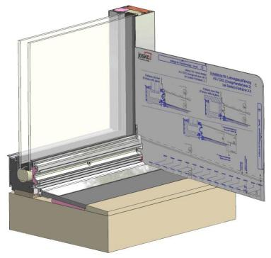
2. Die Mauer muss wie angegeben bis zum Aluprofil abgedichtet werden
