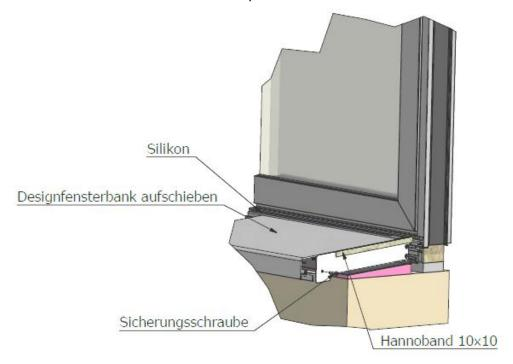
10. Fensterbank fertig eingebaut. Als Dröhnschutz kann noch zusätzlich punktuell ausgeschäumt werden.
