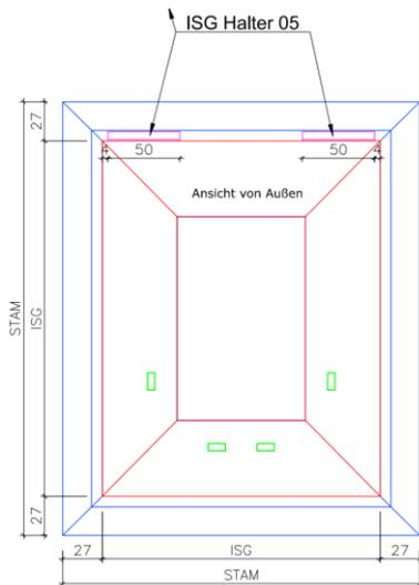
2. Die Halterungen in die Schattennuten einhaken und gegebenenfalls mit einem Hammer und einem Schonklotz vorsichtig von oben einschlagen. Die Halterungen können aufgrund der verschiedenen Alubeschichtungsvarianten unterschiedlich streng einklipsen.
