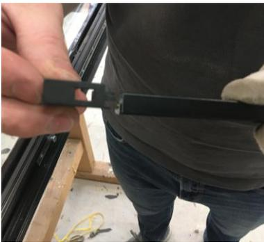
10. Bei den Glaskantenabdeckprofile die Fläche an der die Klebedichtung aufgeklebt wird mit Haftprimer vorbehandeln und die mitgelieferte Klebedichtung aufbringen.
