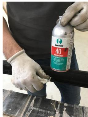
14. Bevor die Folie entfernt wird muss im Eckbereich der Dichtung mit 640 Kleber ausgespritzt werden. Die Folie von der Klebedichtung entfernen, Glasrand reinigen und das Glas einsetzen. Glas lt. Richtlinie ausklotzen
