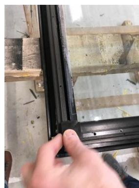
17. Die Schraubenabdeckdichtung wieder in die Nut der Glaskantenabdeckprofile eindrücken, bis unter die Eckkappen und an den Enden mit Superkleber sichern.
