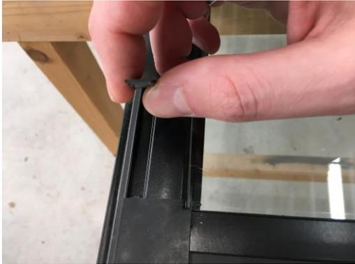
3. Die Schrauben, mit denen das Glaskantenabdeckprofil befestigt ist entfernen. Das Glaskantenabdeckprofil besteht aus 4 Teilen und ist nicht zu einem Rahmen verstanzt. Bei den waagrechten Teilen sind die Eckkappen mit Sekundenkleber befestigt.
