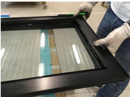
8. Den Flügel und die Glaskantenabdeckprofile von Kleberückständen befreien und reinigen.
