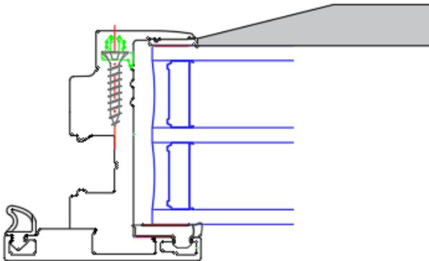
3. Das Glas wurde punktuell, ca. alle 30cm, mit 640 Dichtkleber bis zur mittleren Scheibe ausgespritzt. Den Dichtkleber mit einem scharfen Messer ausschneiden.
