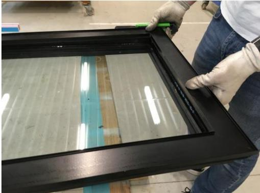
6. Den Flügel und den Verglasungsrahmen von Kleberückständen befreien und reinigen.
