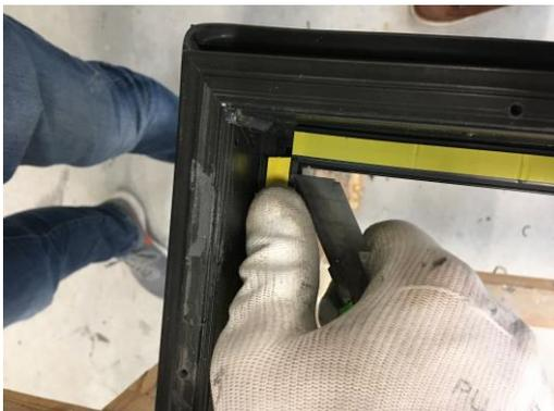
13. Den Zwischenraum zwischen Glas und Rahmen punktuell ca. alle 30cm mit 640 Kleber bis zur mittleren Glasscheibe ausfüllen.
