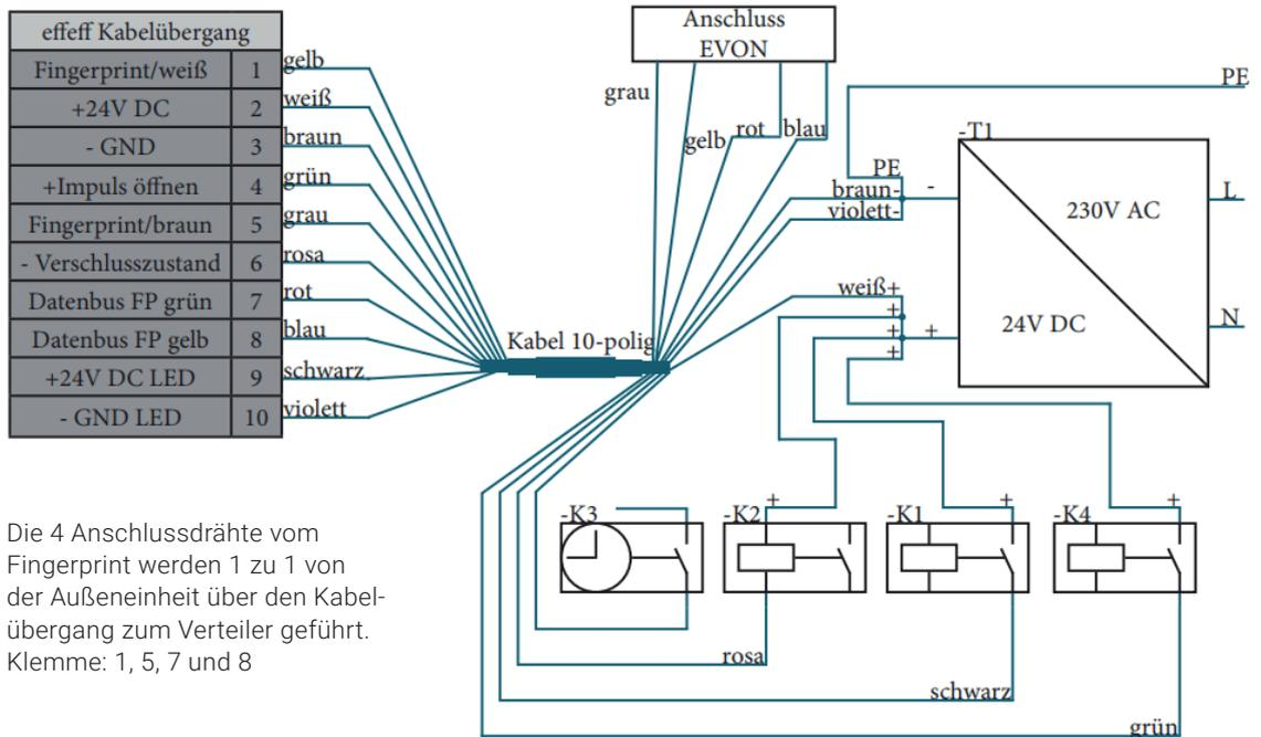
Die 4 Anschlussdrähte vom Fingerprint werden 1 zu 1 von der Außeneinheit über den Kabelübergang zum Verteiler geführt. Klemme: 1, 5, 7 und 8
