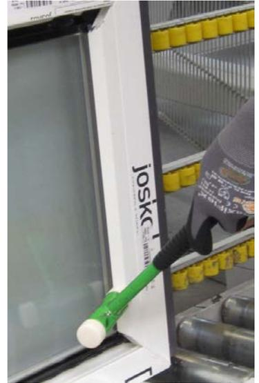
Die langen Glasleisten werden ganz in die Ecken eingeschoben.
