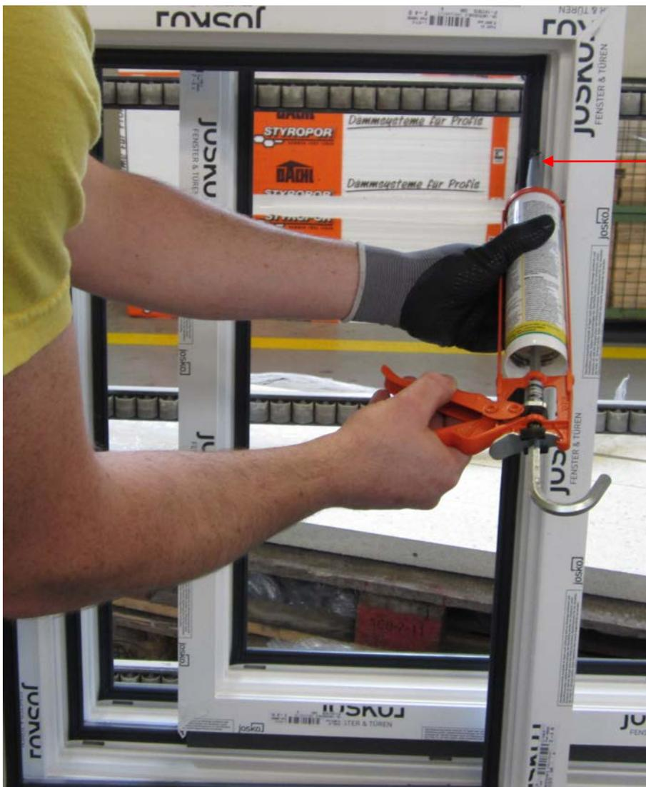
Auf die äußere Verglasungsdichtung wird 3-seitig links, rechts und unten mit Klebesilikon (beigepackt) eine Kleberaube aufgezogen.
