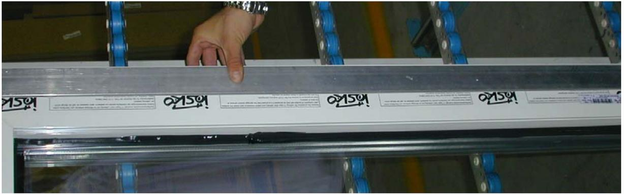
**Auftrag der innenseitigen Verklebung, voll umlaufend mit dem Kleber.**
