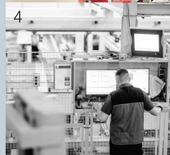
**4 FRÄSEN & ZUSAMMENBAU** Die Fensterprofile werden mit modernsten computer-gesteuerten CNC-Fräsen auf Millimeterbruchteile in Form gebracht. Der Zusammenbau erfolgt durch hochpräzise Holzsteckverbindungen, die zusätzlich noch verleimt werden.
