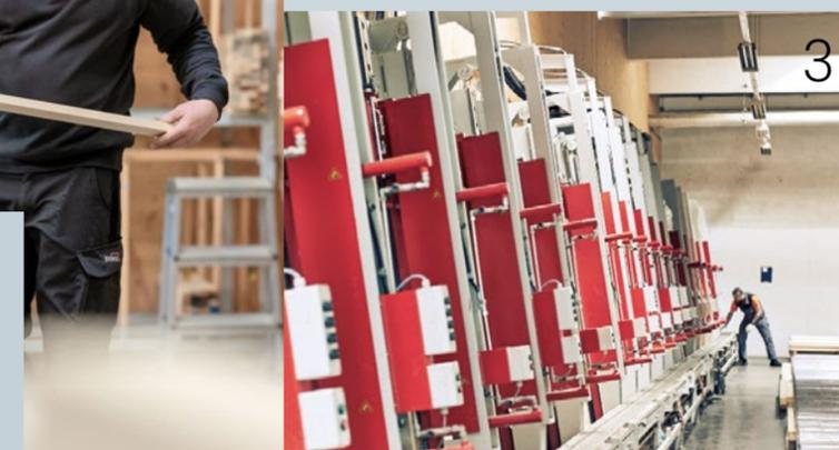
**3 PROFILE LEIMEN & PRESSEN** Die perfekt gefrästen Kantele werden unter Druck zu Profilen verleimt. Der dazu verwendete Leim entspricht klassischer Tischlertradition, die dazu verwendete topmoderne Presse ist allerdings Hightech pur und sorgt für optimale Aushärtung des Leims und perfekte Maßhaltigkeit.
