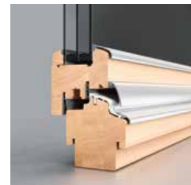
RUBIN 78 Bestwert: U_w 0,76 \text{ W/m}^2\text{K} Systemstärke: 78 mm
