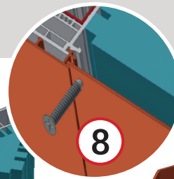
Schraubenabstände ca. 60cm (30cm abwechselnd)
