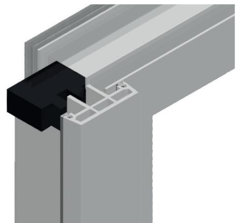
7. Statikkoppelungsprofil mit ● 5,5 x 60mm Selbstbohrschrauben auf das erste Element schrauben
