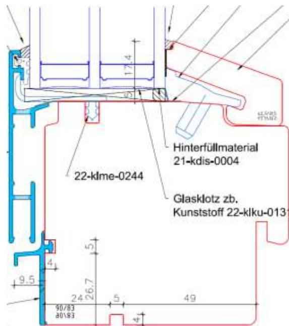
Zuerst Glasleistenrahmen nach innen abnehmen. Dann Fixteil montieren.
