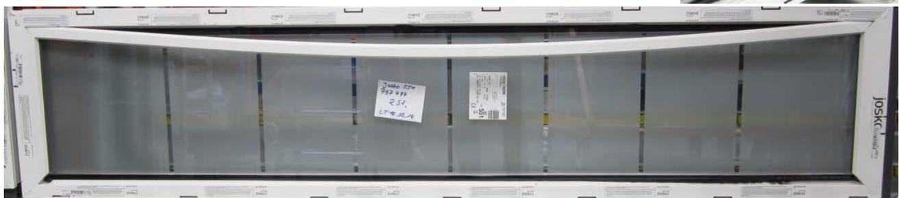
Anschließend werden die Glasleisten von den Ecken beginnend zur Mitte eingeschlagen.
