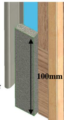
3. Auf eines der beiden zu koppelnden Elemente Komtriband 4/20-20 unmittelbar hinter der Dichtung einseitig aufkleben. Länge des Komtribandes mindestens 100 mm von Stockunterkante
