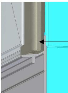
2. Koppelungsdichtung einseitig in Nut der Aluschale so einstecken dass diese am Fensterbankanschlussprofil aufsteht.
