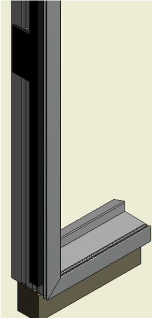
10. Zweites Element mit 4,8 x 45 Selbstbohrschrauben befestigen
