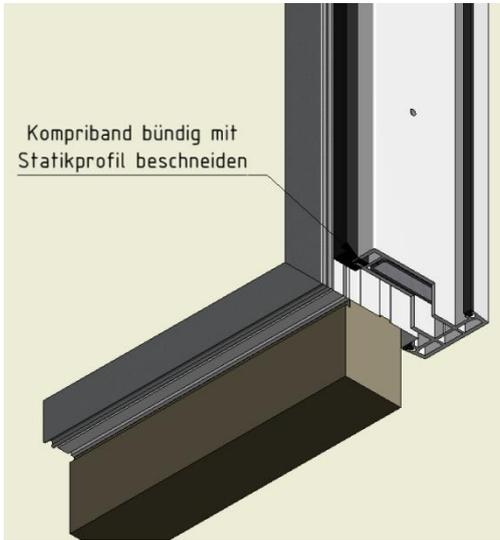
6. Dichtklotz unter Statikkoppelung einsetzen
