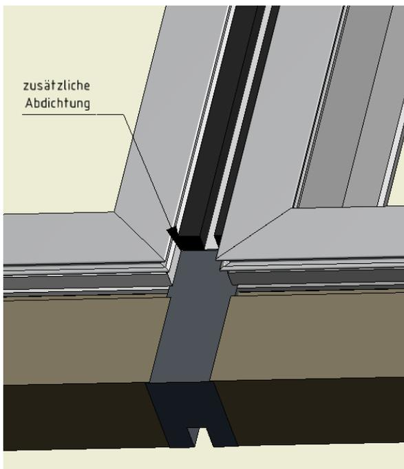
12. Grund – Deckprofil mit 5 x 60mm Selbstbohrschrauben befestigen
