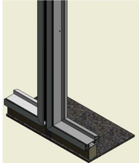
11. im Bereich des Dichtklotzes unten müssen die Fugen zusätzlich mit Dichtkleber versiegelt werden
