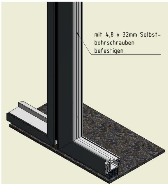
9. im Bereich des Dichtklotzes unten müssen die Fugen **zusätzlich mit Dichtkleber** versiegelt werden
