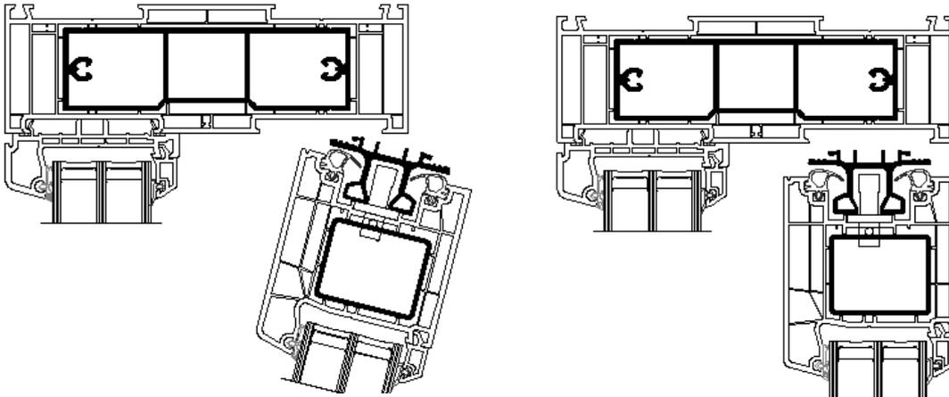
4. Jetzt die obere Führungsschiene nach oben in die Ausnehmung am Rahmen einbringen und mit den Schrauben wieder am Element befestigen.
