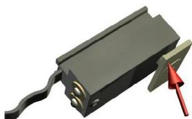
Unter den Stopperrn wird jetzt der zuvor demontierte Klemmflansch wieder handfest angeschraubt. Er verhindert ein seitliches Verschieben der Profile.
