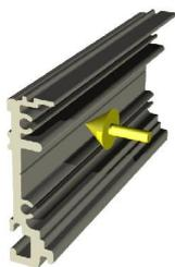
In das Wandträgerprofil müssen 5 mm Löcher gebohrt werden mit folgenden Abständen: 100 mm vom Ende dann weiter mit einem Abstand von ca. 360 mm. Der äußere Bohrungsabstand zum Schienen-Ende darf die 100 mm nicht überschreiten.
