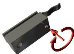
Tür soweit zuschieben, dass die Laufwerke von der Haltefeder gehalten werden. Ist hier eine Änderung der Haltekraft gewünscht, lässt sich die Kraft an dem vorderen Gewindestift justieren.
