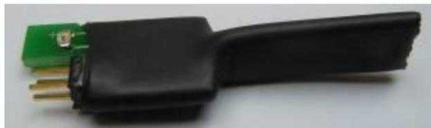
Abbildung des Service-Dongles, die Nase dient als Verpolschutz
