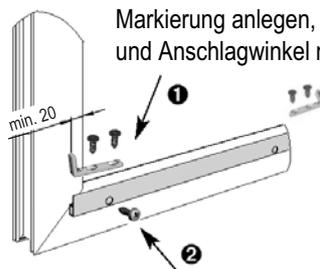
Laufschiene leicht nach außen biegen, Vorderkante NEHER - Bohrlöcher 164850 (optional) an der Markierung anlegen, mit Bohrer 2,2 mm vorbohren und Anschlagwinkel mit SK 2,9 x 9,5 anschrauben.
