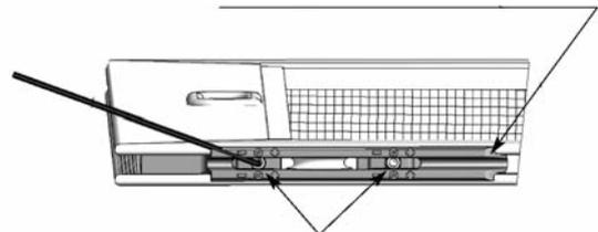
Gewindestift mit Innusschlüssel 2,5 mm lösen und den Kunststoffrollenhalter nach - oder + verschieben. Anschließend die Gewindestifte wieder anziehen.
