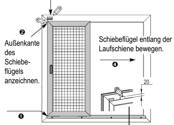
Außenkante des Schiebeflügels anzeichnen. Schiebeflügel aufsetzen und gegen den Endanschlag fahren. Oberkante Positionierlehre mehrfach anzeichnen.
