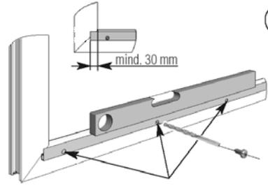
Bei Holz- und Kunststoffenster mit Bohrer 2,2 mm vorbohren. Bei Alufenster mit Bohrer 2,9 mm vorbohren.
