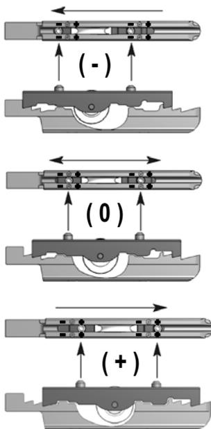
Durch Verschieben des Kunststoffrollenhalters in die (-) Richtung, wandert der Schiebeflügel auf dieser Seite um 1 mm nach unten.
