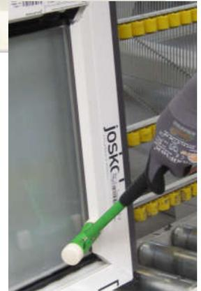
Die langen Glasleisten werden ganz in die Ecken eingeschoben.
