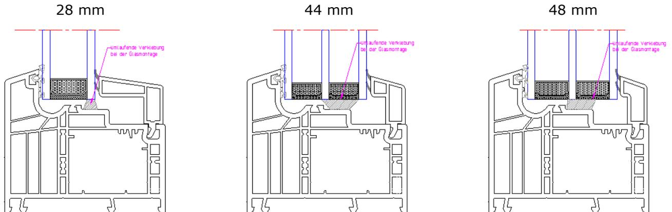
1. Schritt: untere Glasklötze positionieren
