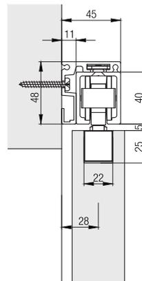
Weitere Einbaubeispiele mit Distanzschiene
