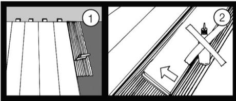
BILD 1: Bei zügiger Verlegemöglichkeit können 2 bis 3 Dielenbreiten an Trapa Hybridklebstoff aufgebracht werden. Nach dem Verlegen der Dielen empfehlen wir, diese punktuell im Klebebett zu beschweren.
