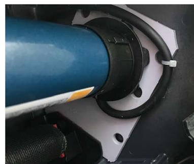
Die Blendkappeneinsätze für das integrierte Insektenschutzrollo müssen oben beschnitten werden.
