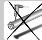
Das Versorgungskabel immer mit einer Schlaufe verlegen, so dass kein Wasser an ihm entlang laufen und in den Antrieb eindringen kann!
